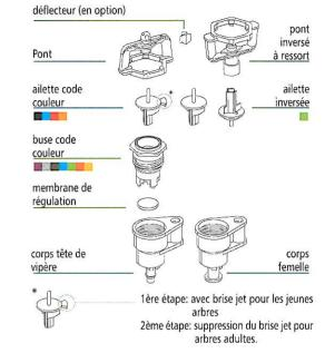
Filtration recommandée 35l/h et moins - 130 microns 47l/h et plus -200 microns
