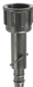
Embase taraudée 1/2" permet le raccordement du MEGANET sur du PE 8/12 mm ou PE 16 4 bar pour les débits supérieurs à 350 l/h.
