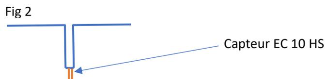
Certaines personnes utilisent un morceau de PVC dans lequel il font une encoche pour tenir le capteur sur le bout pour pouvoir diriger le capteur dans le trou. Il plante alors le capteur et retire le morceau de PVC.
