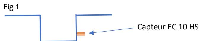
Rasez un peu la surface verticale du sol et insérez le sur toute la surface des broches. Chaque broche est pointue pour faciliter l'enfoncement. Reboucher la tranchée en prenant soin de remettre une densité apparente naturelle autour du boîtier noir du capteur.
