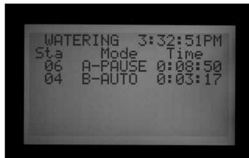
Les diagnostics d'alarme consistent à mettre en pause toutes les opérations, puis à démarrer individuellement chaque station qui était en marche au moment de l'alarme. Le débit de chacune de ces stations suspectes est échantillonné seul, afin de vérifier s'il est à l'origine du sur-débit. Si le programmeur identifie une station comme ayant un débit élevé, il crée un rapport d'échec d'irrigation et essaie de continuer l'arrosage avec les autres stations.
