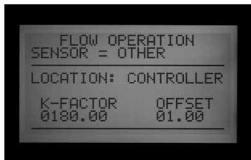
La plupart des autres marques de sonde de débit requièrent deux paramètres pour le calibrage : K-factor (Facteur K) et Offset (Décalage). Les valeurs correctes pour ces paramètres figurent dans la documentation du fabricant de la sonde, et dépendent du type et de la taille du tuyau.
