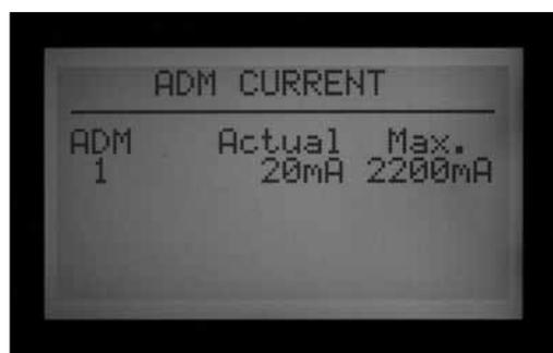
Cette option permet d'afficher la consommation électrique en milliampères (mA) de tous les décodeurs connectés au module de sortie à décodeur (ADM). Elle est utilisée à des fins de diagnostic.
