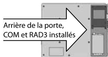
5. Le câble-ruban de la radio a un connecteur rectangulaire à 14 broches à une extrémité pour le module Com, et un connecteur DB-9 à 9 broches à l'autre extrémité pour la connexion à la radio. Le connecteur à 14 broches ne peut se brancher que d'une façon, et est marqué pour aider à une orientation correcte. Alignez le connecteur et enfoncez-le en place en haut du module Com.
