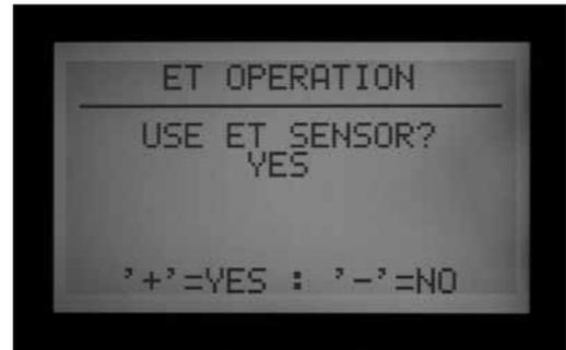
L'écran du programmeur affiche alors « Current ET: x.xx » (ET actuelle :x.xx) en pouces ou en millimètres, lorsque vous tournez à nouveau le bouton rotatif sur la position Run (Exécuter). En outre, une fois le fonctionnement de la sonde ET activé, et réglé sur YES (OUI), le menu ET FUNCTIONS (FONCTIONS DE LA SONDE ET) présente plus d'options.
