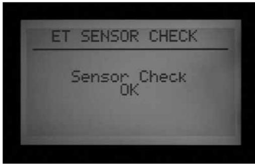
Si le test échoue (la sonde ET ne répond pas), vérifiez le câblage de la sonde, puis réessayez. Notez que la connexion de la sonde ET est polarisée (la borne verte du module maître de l'ACC doit être connectée à la borne verte de la sonde ET, et la borne noire à la borne noire).
