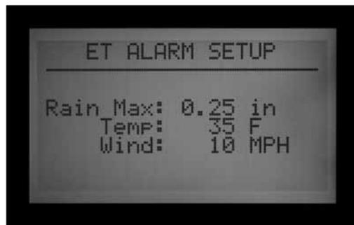
Le pluviomètre ET arrête les programmes lorsque des précipitations de 0,51 mm sont atteintes en une heure (cette valeur n'est pas paramétrable), mais le programme peut être exécuté à nouveau si aucune autre pluie n'est détectée. La sonde ET vérifie les précipitations toutes les 15 minutes.
