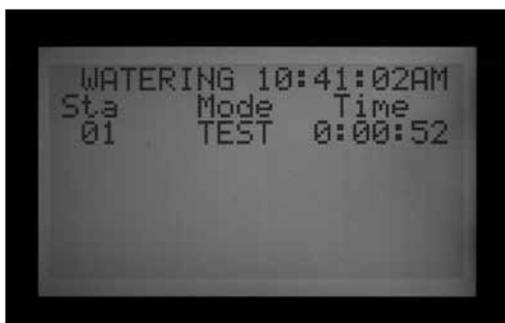
Le test ne lance pas les SSG ni les programmes. Il active chaque sortie de station individuellement et successivement.
