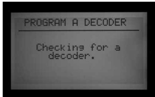
7. Le module de sortie à décodeur recherche la présence d'un décodeur. Si les fils sont correctement insérés dans le port de programmation, un écran s'affiche avec les paramètres du décodeur.
