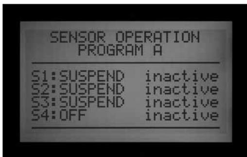
Les arrêts de la sonde ET ne sont pas instantanés, et il peut y avoir un délai de jusqu'à 18 minutes entre une alarme de la sonde ET et l'arrêt réel. Si cette situation n'est pas acceptable, une sonde indépendante (comme Rain-Clik ou Freeze-Clik) doit être installée et reliée directement à une des entrées Sen 1-4 pour des arrêts instantanés.
