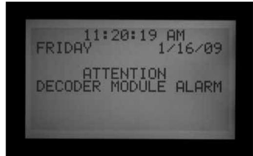
Dans les programmeurs à décodeur, la surintensité peut avoir des causes plus complexes, mais indique toujours une intensité élevée inacceptable sur la ligne du décodeur.
