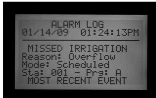
Les entrées du journal des alarmes dénommées « Missed Irrigation » (Échec d'irrigation) sont importantes, car elles ont provoqué l'annulation de l'arrosage de stations. La raison de l'échec d'irrigation est toujours indiquée : « Overcurrent » (surintensité électrique) ou « Overflow/Underflow » (sur-débit / sous-débit hydraulique), etc. Une liste complète des messages possibles du journal des alarmes figure à la fin de ce manuel.
