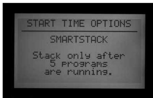
SmartStack limite les opérations simultanées au nombre de stations spécifié ici. L'opérateur peut programmer autant de programmes chevauchants qu'il le souhaite, le programmeur permettra le chevauchement jusqu'au nombre spécifié ici et décalera le reste.
