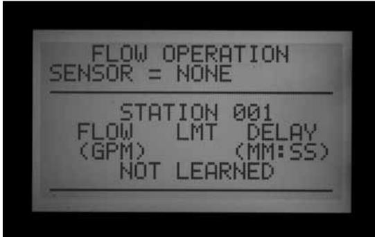
Maintenez le bouton INFORMATION enfoncé tout en tournant le bouton rotatif sur la position SET FLOW MONITORING (RÉGLAGE DE LA SURVEILLANCE DU DÉBIT). Appuyez une fois sur le bouton fléché vers le bas pour faire clignoter le curseur sur SELECT FLOW SENSOR (SÉLECTIONNER LA SONDE DE DÉBIT).
