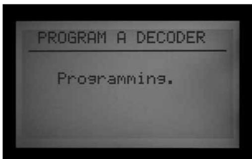
9. Lorsque les paramètres du décodeur sont corrects, appuyez sur le bouton Program (Programme) pour les envoyer au décodeur. L'écran affiche « Programmation... » pendant quelques secondes jusqu'à ce que les informations soient téléchargées dans le décodeur.
