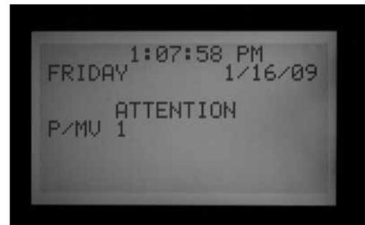
Une surintensité de station dans un système à décodeur indique une condition de haute consommation du côté de la sortie du décodeur, vers les solénoïdes et, en général, un solénoïde court-circuité.
