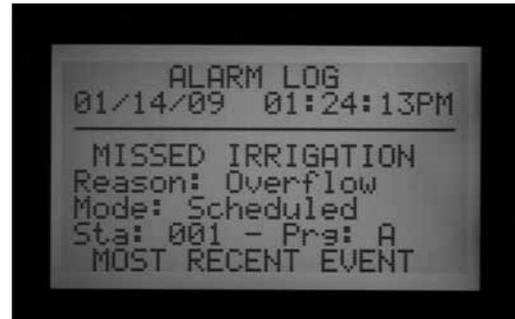
Les entrées du journal des alarmes dénommées « Missed Irrigation » (Échec d'irrigation) sont importantes, car elles ont provoqué l'annulation de l'arrosage de stations. La raison de l'échec d'irrigation est toujours indiquée : « Overcurrent » (surintensité électrique) ou « Overflow/Underflow » (sur-débit / sous-débit hydraulique), etc. Une liste complète des messages possibles du journal des alarmes figure à la fin de ce manuel.
