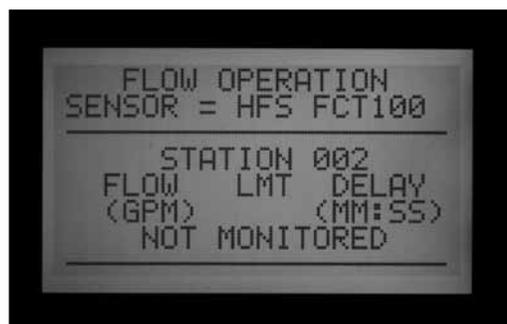
5. Si la sélection de la sonde de débit a été changée pour NONE (AUCUNE) après la lecture, l'écran affichera FLOW NOT MONITORED (DÉBIT NON SURVEILLÉ). Le débit réel peut toujours être affiché, même si toutes les stations ont été réglées sur Not Monitored (Non surveillé). Les diagnostics d'alarme au niveau de la station ne seront pas disponibles, mais le débit sera visible.
