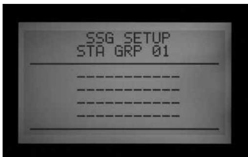
6. Le premier SSG possible est présenté comme STA GRP 01 (GR. STAT. 01), et affiche 4 lignes (lignes en pointillé dans une nouvelle installation, numéros de station si la programmation a déjà été réalisée). Chaque ligne correspond à une station qui peut être incluse dans le SSG.
