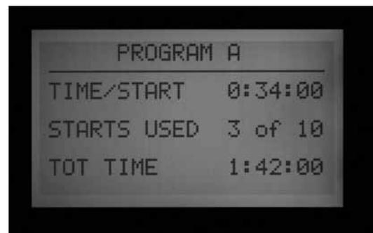
Appuyez sur le bouton Information dans la position Set Watering Start Times (Réglage des heures de départ de l'arrosage) pour afficher un résumé de toutes les informations sur les heures de départ du programme sélectionné. L'écran affiche la durée totale de fonctionnement des stations par départ, le nombre de départs et la durée totale du programme.
