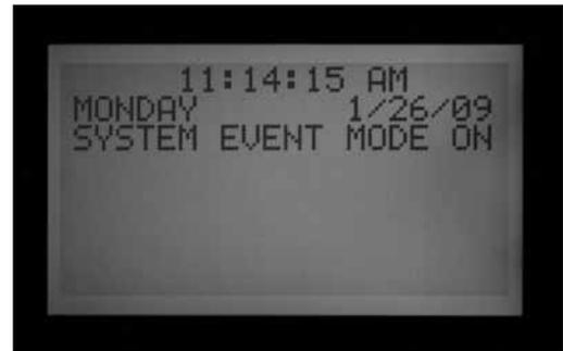
Il n'y a pas d'écran spécial lorsque le programmeur est dans le mode FCP normal. Si System Event Mode On (Mode événement du système activé) n'est pas affiché dans la position Run (Exécuter), cela signifie que le programmeur est dans le mode FCP.
