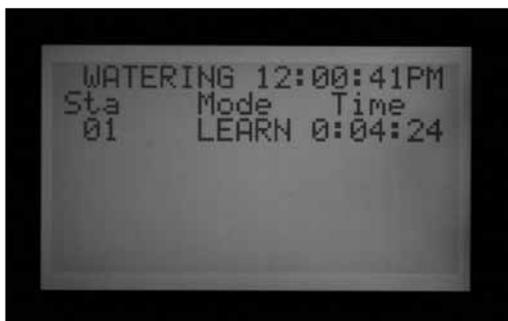
Seules les stations avec une durée de fonctionnement dans un programme automatique sont lues. Les stations qui ne sont programmées dans aucun programme ne sont pas échantillonnées, et doivent être réglées sur Not Monitored (Non surveillé) pour assurer un fonctionnement correct du débitmètre.
