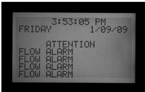
Puisque l'ACC peut faire fonctionner plusieurs stations à la fois (Chevauchement, SSG, etc.), il ajoute les débits lus pour toutes les stations en fonctionnement, et compare le total au débit réel, en temps réel. Si une alarme se produit avec plusieurs stations, l'ACC entre dans le mode diagnostic pour essayer d'isoler les stations qui ont un problème.
