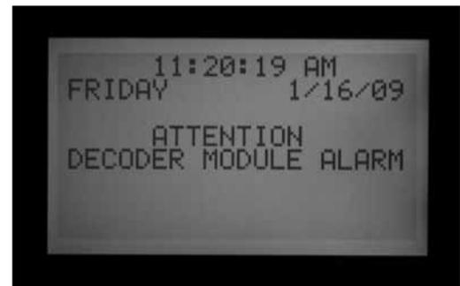
Dans les programmeurs à décodeur, la surintensité peut avoir des causes plus complexes, mais indique toujours une intensité élevée inacceptable sur la ligne du décodeur.
