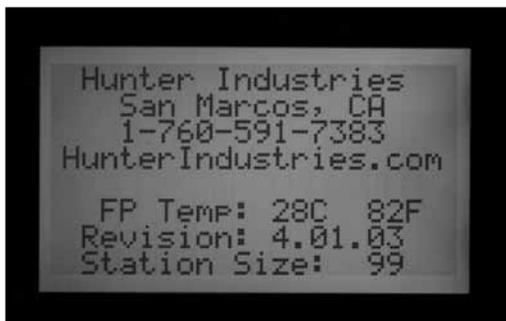
Si la taille en stations est incorrecte, ou indique « 0 » ou « 1 », vérifiez que le curseur Powerlock est dans la position ON (verrouillé). Vérifiez que tous les contacts de module de station sont dans le bon ordre et que les modules sont bien insérés. Assurez-vous que les pattes Powerlock à l'avant des modules sont bien en contact avec le curseur de verrouillage. Un nombre incorrect de stations qui persiste une fois toutes les vérifications réalisées peut être dû à un module endommagé.
