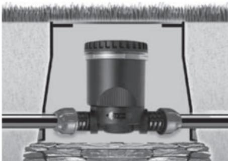
**Attention** : pour obtenir l'étanchéité du produit s'assurer que le groupe de commande est aligné et installé sur le repère ad hoc **1** et que le couvercle transparent est parfaitement vissé, avec le joint d'étanchéité en place sur son logement **2**.
