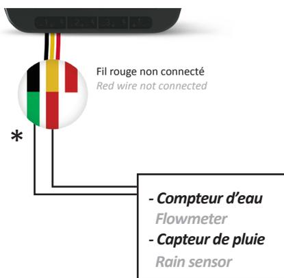
\* La couleur des fils des capteurs dépend du type de capteur utilisé
