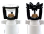
Les deux modèles de mini-Wobbler tête en haut sont disponibles avec un raccord couissant antivol. Il vous suffit de coller un montant en PVC de 1/2" à l'intérieur de la base du raccord couissant, ou de coller un montant en PVC de 3/4" à l'extérieur de la base du raccord couissant. Aucun raccord en PVC n'est nécessaire pour l'installation.
